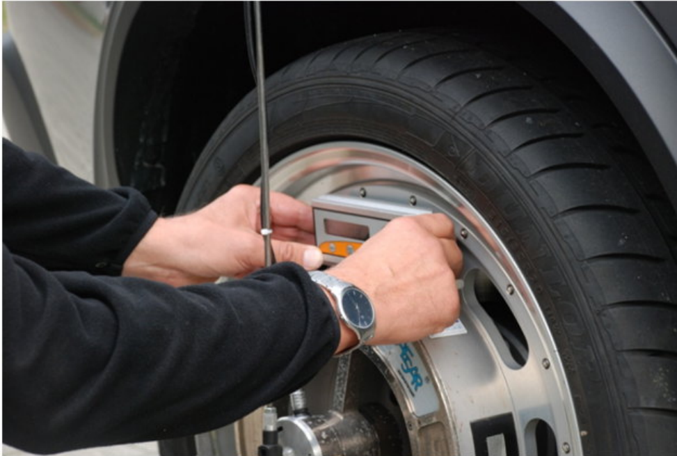
Abb. 28: Messen mit der Wasserwaage
